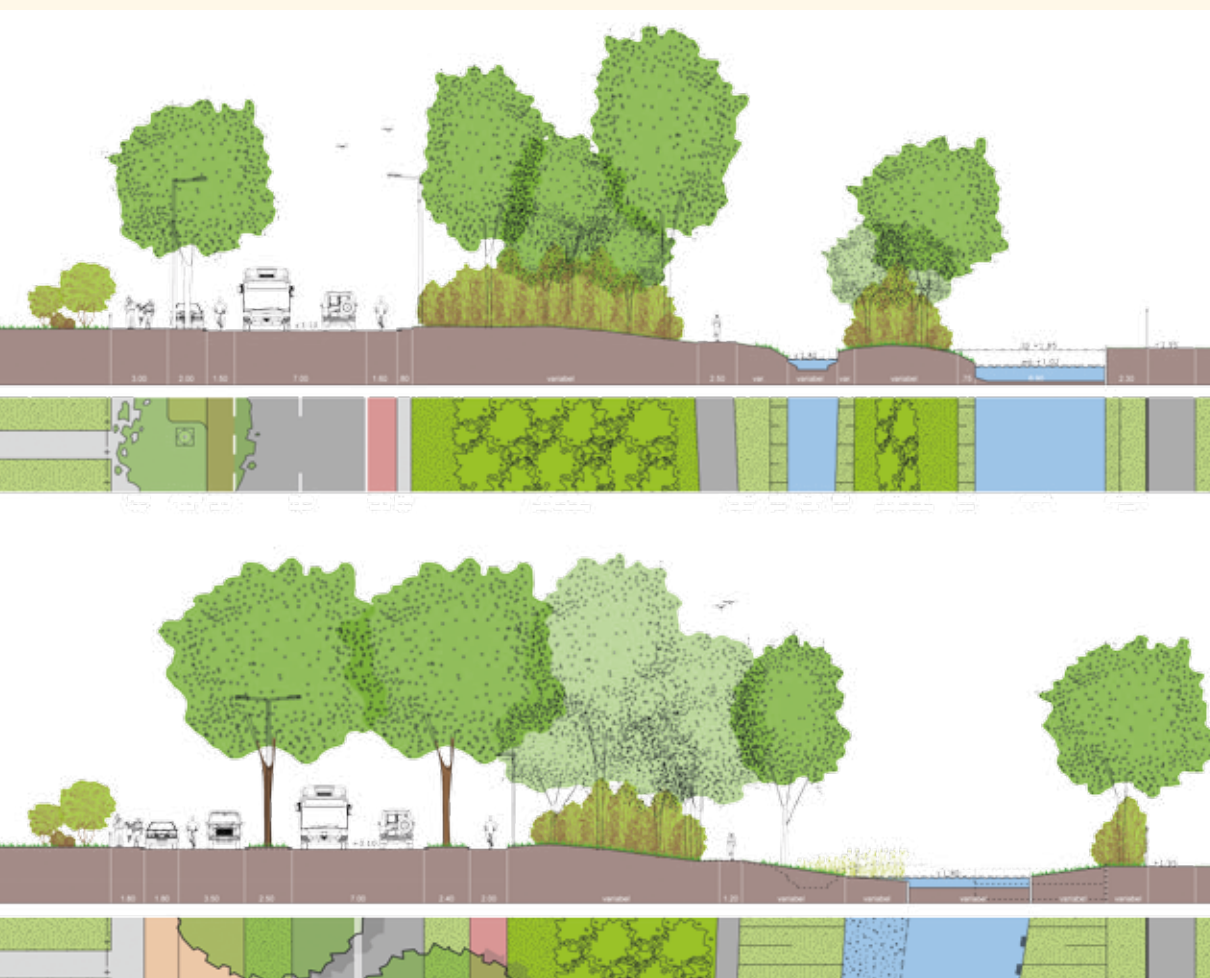
Doorsnede Sportlaan ongeveer ter hoogte van de Oude Buizerdlaan. Boven: bestaande situatie. Onder: ontworpen situatie.
